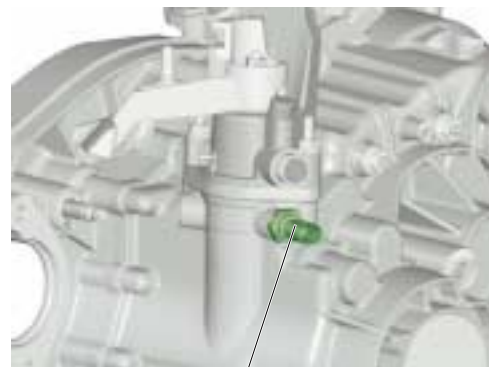
Conmutador para luces de marcha atrás F4
