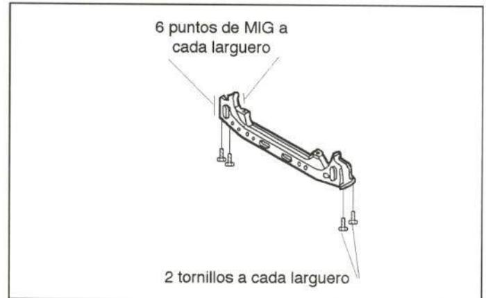
**Figura 28.-** Unión de la traviesa inferior
