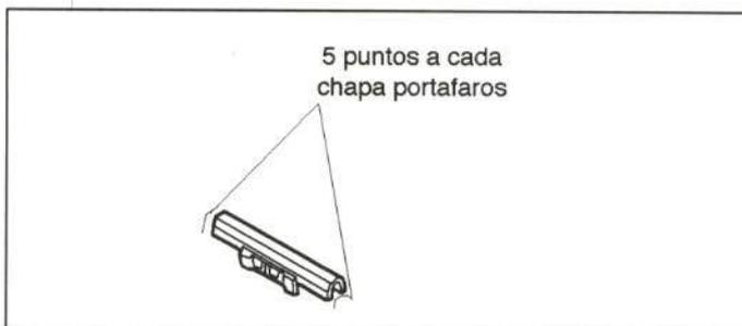
Figura 24.- Unión de la travesía superior
