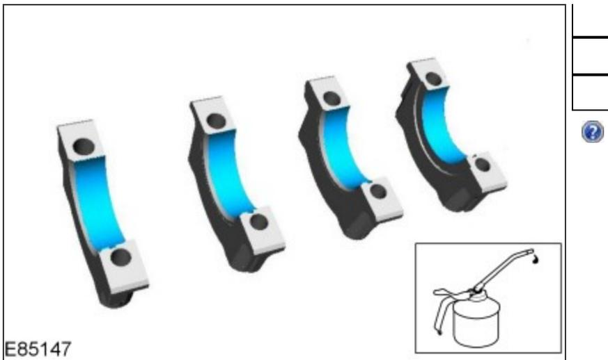
6. **NOTA:** Asegúrese de instalar estos componentes conforme a la posición marcada antes de su desmontaje.
