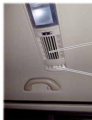
Ausströmer im Dachhimmel - für Klimatisierung der Raumluft
