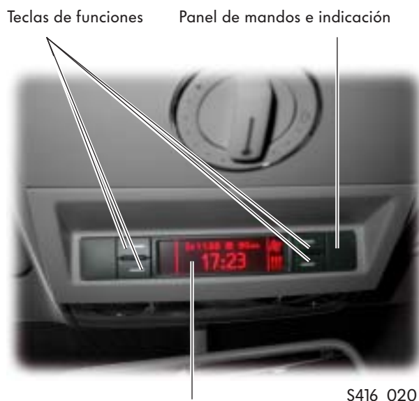
Pantalla de la calefacción adicional (la representación visual corresponde a la de la Thermo Top C)
