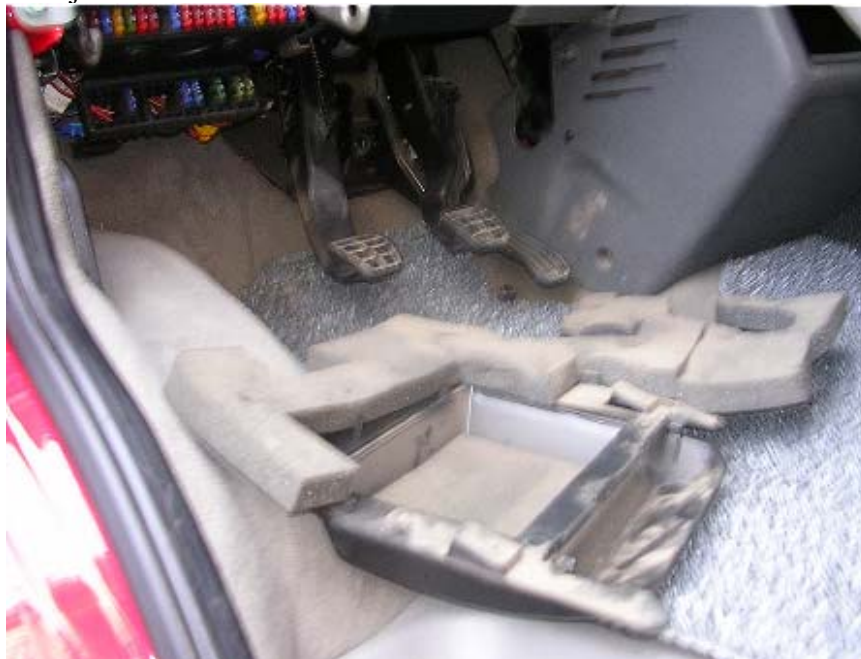
Fotografía 25. Tapa negra inferior de los fusibles.
