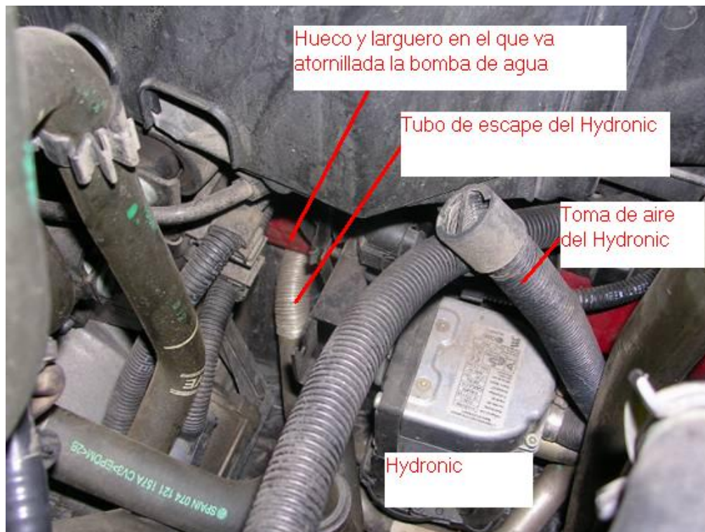
Fotografía 7. Vista superior del Hydronic y dónde se colocará la bomba
