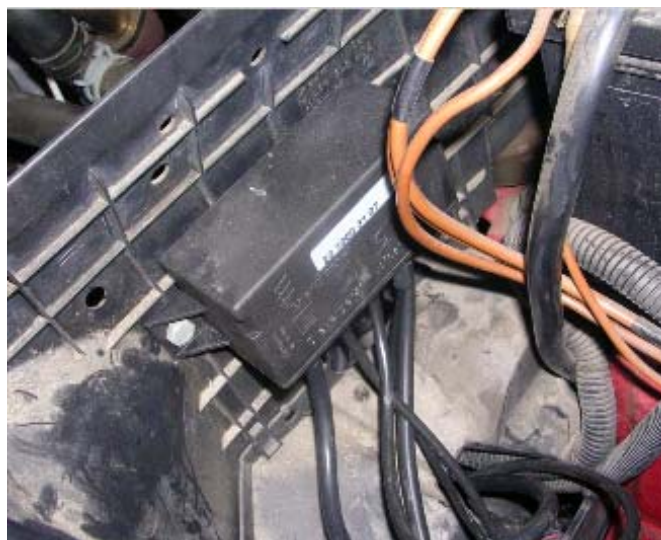
Fotografía 22. Sujeción de la unidad de control
