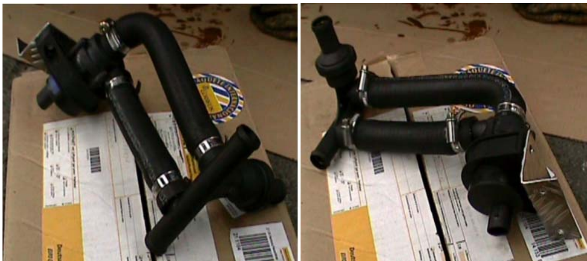
Fotografía 9 y 10. Montaje bomba, manguitos y válvula combinada.
