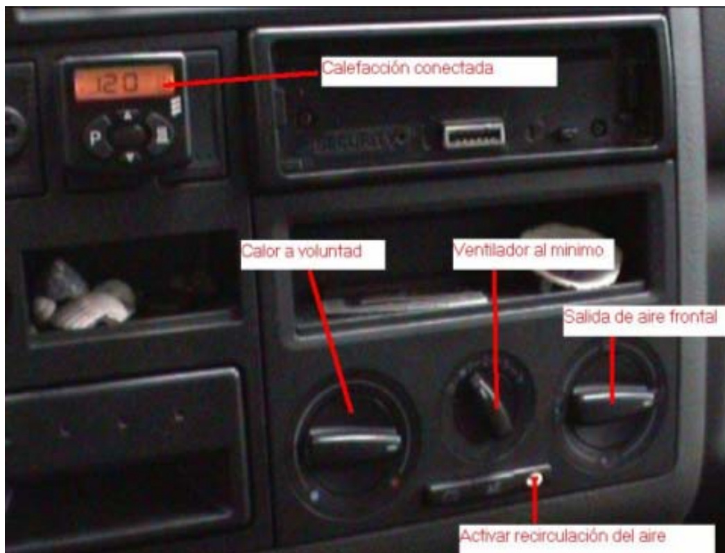
Fotografía 32. Calefacción en funcionamiento.
