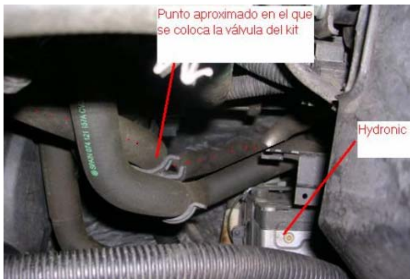
Fotografía 12. Lugar dónde se coloca la válvula combinada (vista superior).
