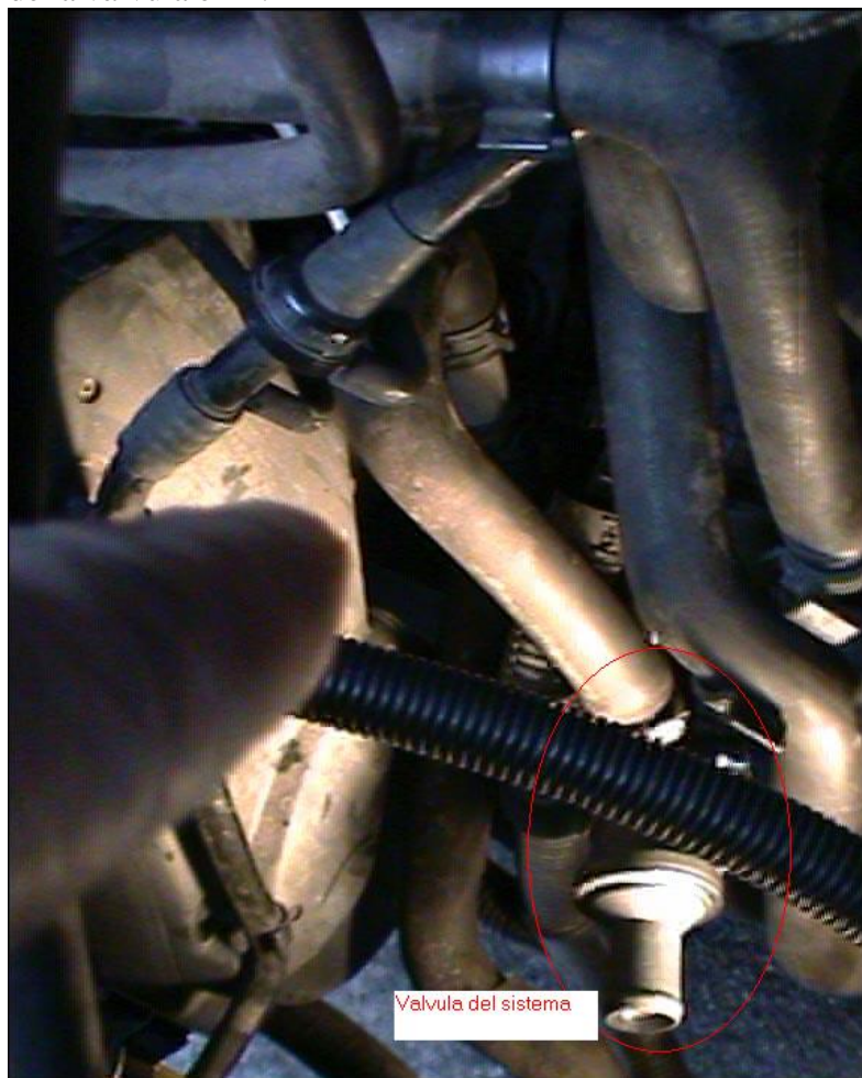
Fotografía 13. Válvula combinada y extremo a unir a la válvula en T
