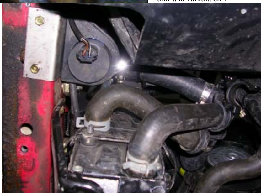
Fotografía 13. Válvula combinada y extremo a unir a la válvula en T
