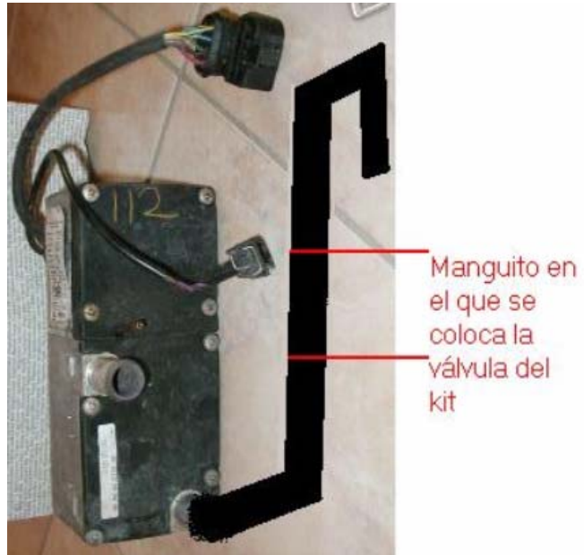
Fotografía 11. Lugar dónde se coloca la válvula combinada
