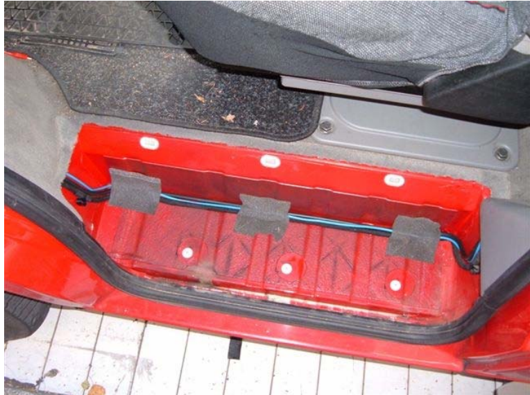
Fotografía 34.- Positivo de batería auxiliar a cuadro principal
