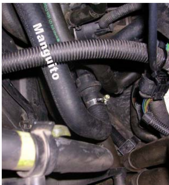
Fotografía 19. Manguito saliendo de la válvula combinada hacia la T del kit
