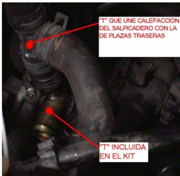
Fotografía 16. T de unión de calefacciones y T del kit montada
