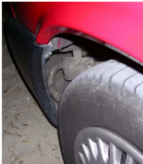
Foto 2. Situación tubo escape precalentador de calefacción Hydronic D3WZ
