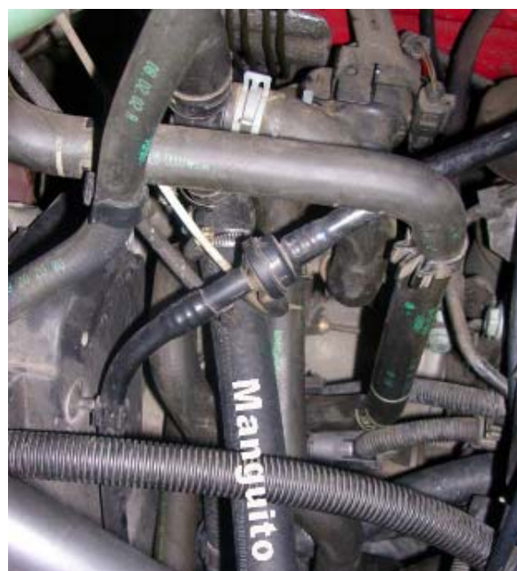
Fotografía 20. Manguito saliendo de la T hacia la válvula combinada
