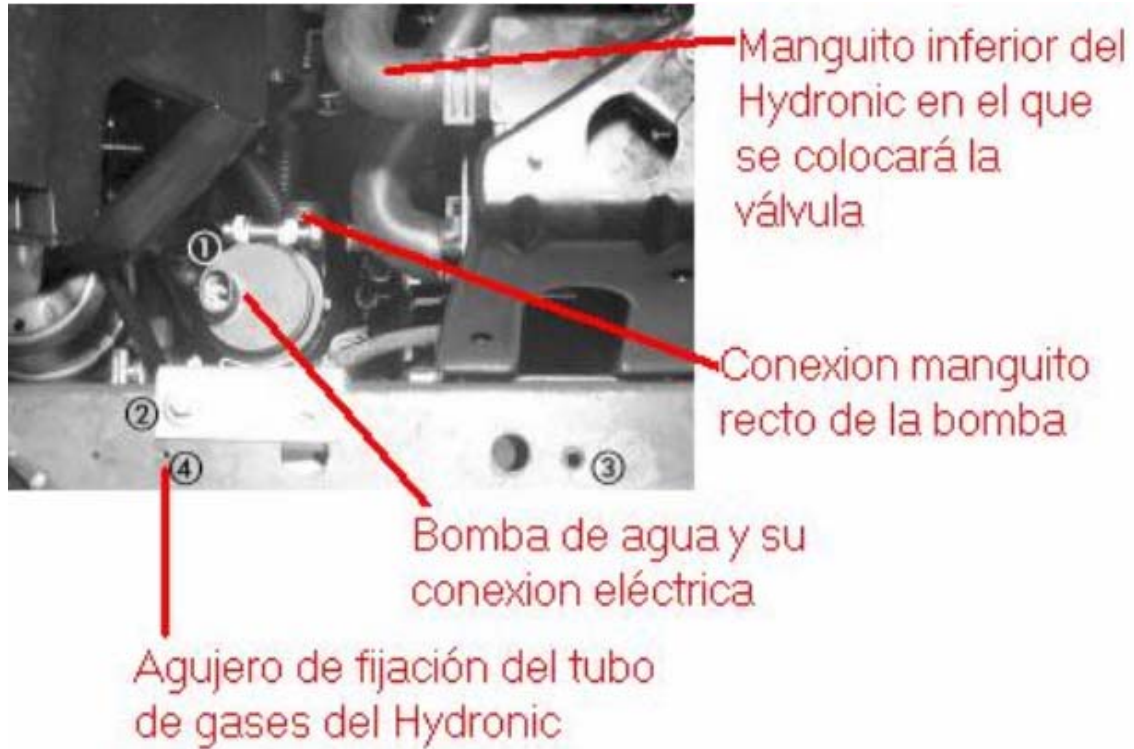
Fotografía 6. Posicionamiento de la bomba
