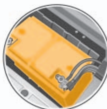
Caja de fusibles (SA) a la derecha de la batería, hay que desmontar ésta para poder verla
