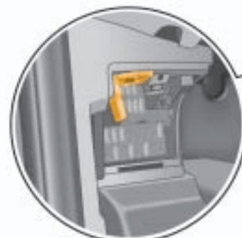
Conector (T16) terminal de diagnosis, en el pilar A izquierdo
