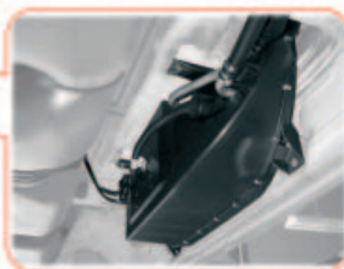
Intercambiador de calor para el compartimento de carga/pasajeros (con turbina); aquí también puede ir montada la calefacción independiente de aire caliente
