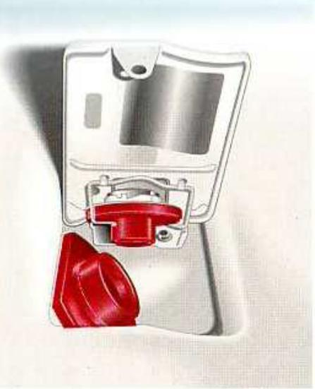
La boca de llenado de combustible se encuentra en el lado izquierdo del vehículo, detrás de una tapa. En los vehículos con cierre centralizado, al estar bloqueadas las cerraduras está asimismo bloqueada la tapa del depósito. Para abrirla hay que desbloquear el vehículo mediante el cierre centralizado. El tapón cerradizo de la boca de llenado se desbloquea con la llave del vehículo.
