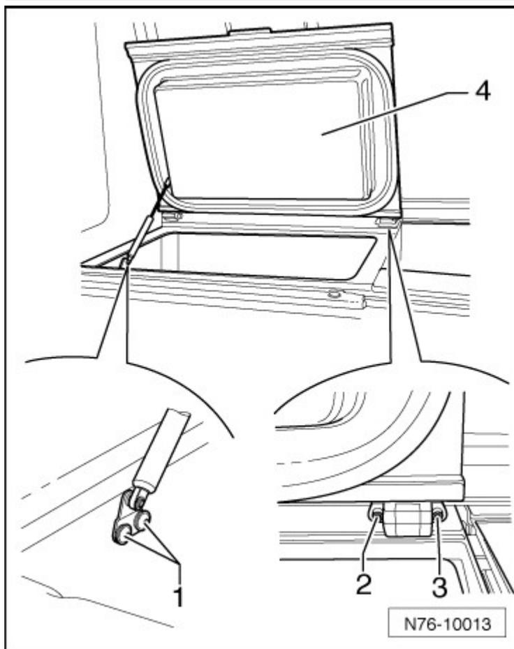
Enroscar a mano el tornillo para el soporte del muelle de gas presurizado -1-.
