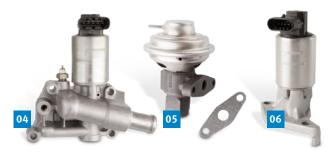
Las válvulas EGR de los motores de gasolina tienen unas secciones transversales mucho más pequeñas.
