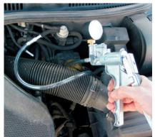
No importa si se trata de válvulas EGR neumáticas o, como aquí, de un convertidor de presión: la función puede comprobarse fácilmente con una bomba manual de vacío.
