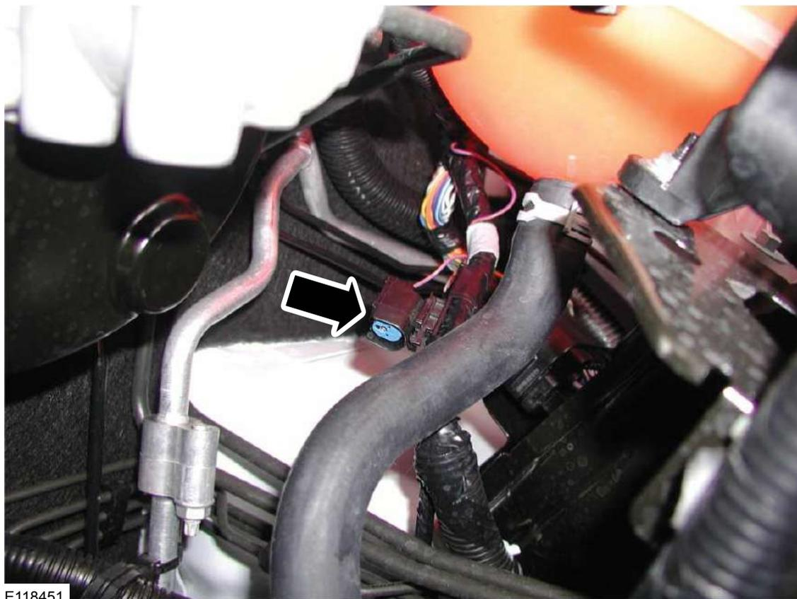
Para los conectores centrales en caravanas, el acceso a la velocidad del vehículo en el compartimento motor está cerca del cilindro principal y el depósito de refrigerante.
