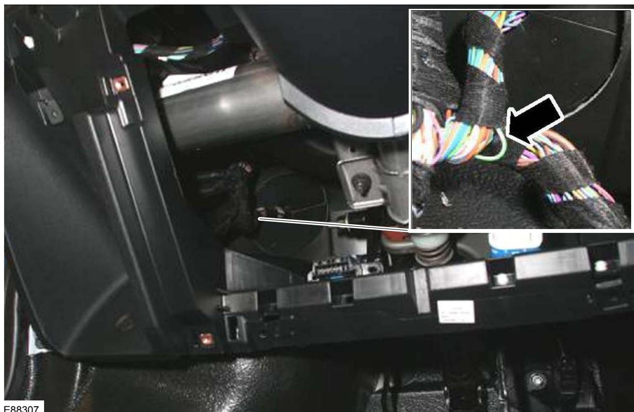
La circuitería eléctrica principal entra desde el compartimiento motor a la cabina del vehículo por la parte izquierda de este a través de un orificio de gran diámetro situado en el compartimiento motor/mamparo de la cabina. Este orificio está justo encima de la tapa de la suspensión del lado izquierdo. Consulte la siguiente figura E88307.
