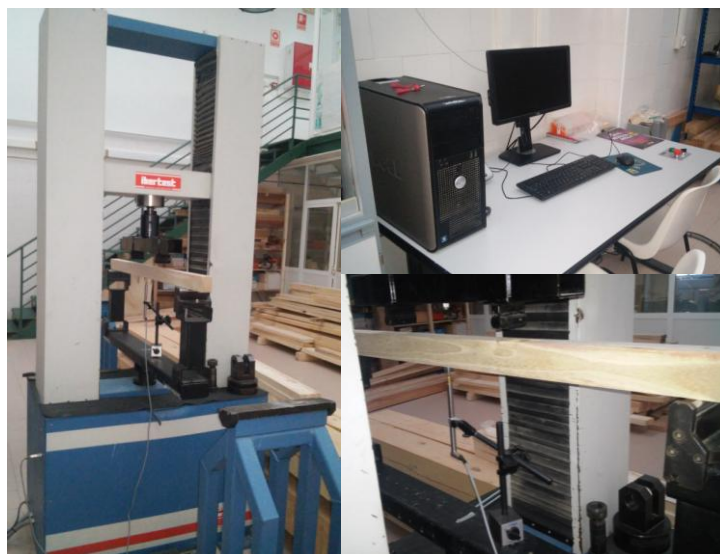
Figura 21. Máquina universal "Ibertest", ordenador, extensómetro y travesaño.
